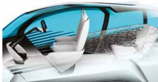
I sedili sono sviluppati con la stessa lavorazione 3D che assicura alla vettura una struttura leggera e ad elevata rigidità.
